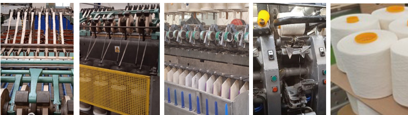
Etireuse, filature mouillée, bobinage et bobines de fil de lin chez SAFILIN.
